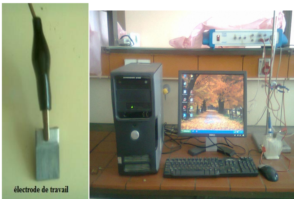
Figure II.1 : Dispositif expérimental utilisé pour les mesures électrochimiques
