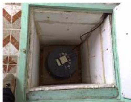
**Figure III.7 :** Sismomètre large bande
