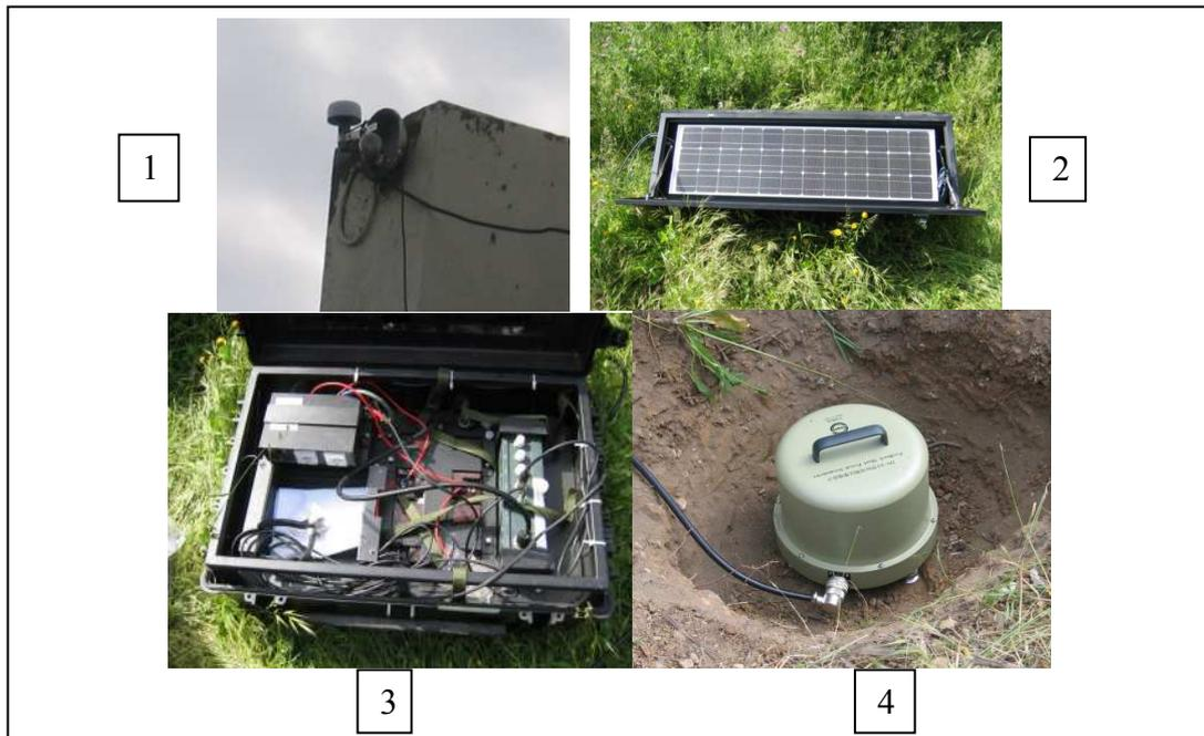
**Figure V.5 :** Station sismologique. 1- Système GPS ; 2- Panneau solaire ; 3-Boitier de la station ; 4- Sismomètre.
