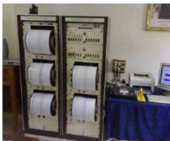
**Figure III.2 :** Sismographe à la station analogique régionale de Constantine.
